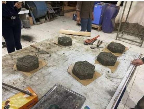
Gambar 7.5. Proses Pengeringan Paving Block
