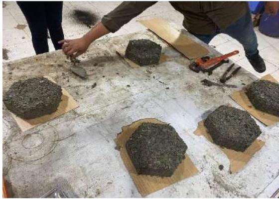
Gambar 7.4. Hasil Cetakan Paving Block
