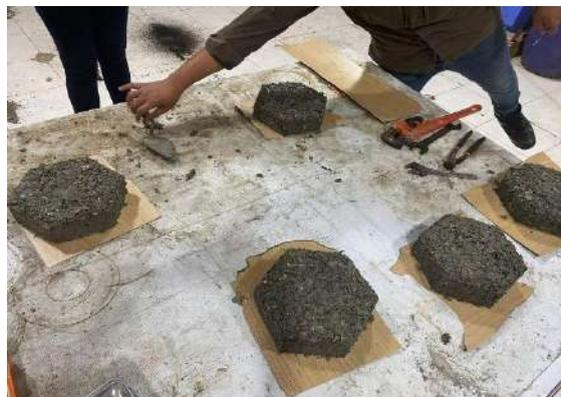
Gambar 7.4. Hasil Cetakan Paving Block
