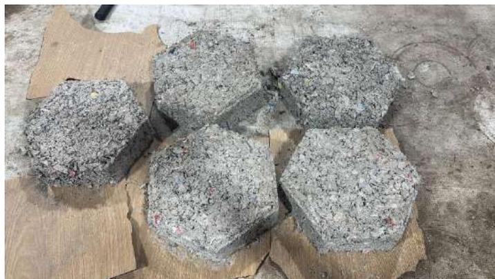
Gambar 7.6. Hasil Pengeringan Paving Block
