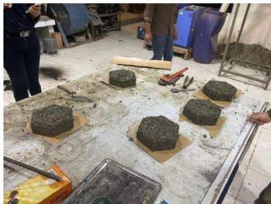
Gambar 7.5. Proses Pengeringan Paving Block
