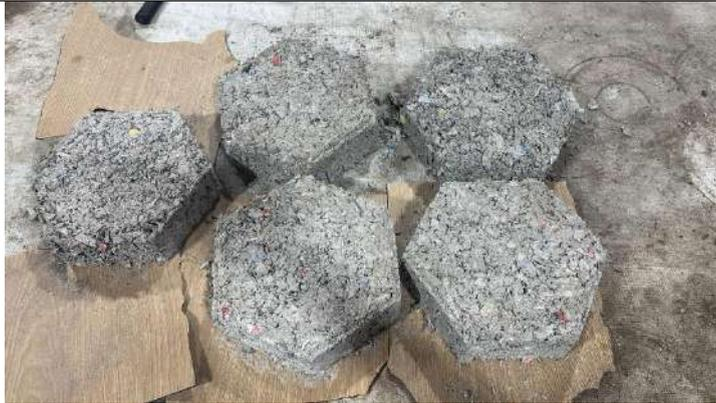
Gambar 7.6. Hasil Pengeringan Paving Block
