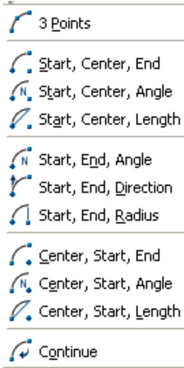
Gambar 4.19 Sub menu **Arc** untuk menggambar busur
