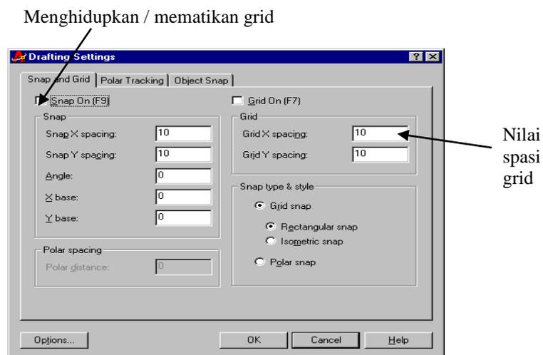
Gambar 4.3. Kotak dialog *Snap* dan *Grid* dari Drafting Setting
