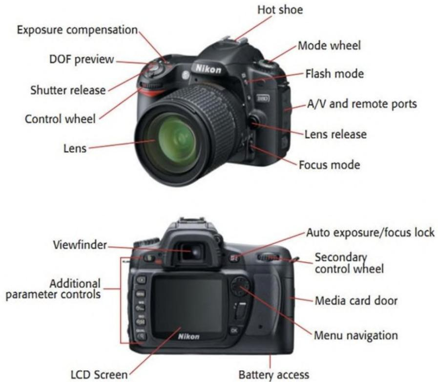
Kamera dibagi menjadi 2 bagian utama, yaitu Lensa dan Body Camera, lensa adalah bagian paling depan kamera yang pertama kali menangkap cahaya dan Body Camera adalah bagian yang memproses cahaya menjadi sebuah data gambar.
