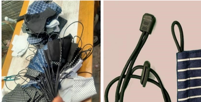
Gambar III.3 Proses menambahkan adjuster pada masker Sumber: Dokumentasi Pribadi, 2020
