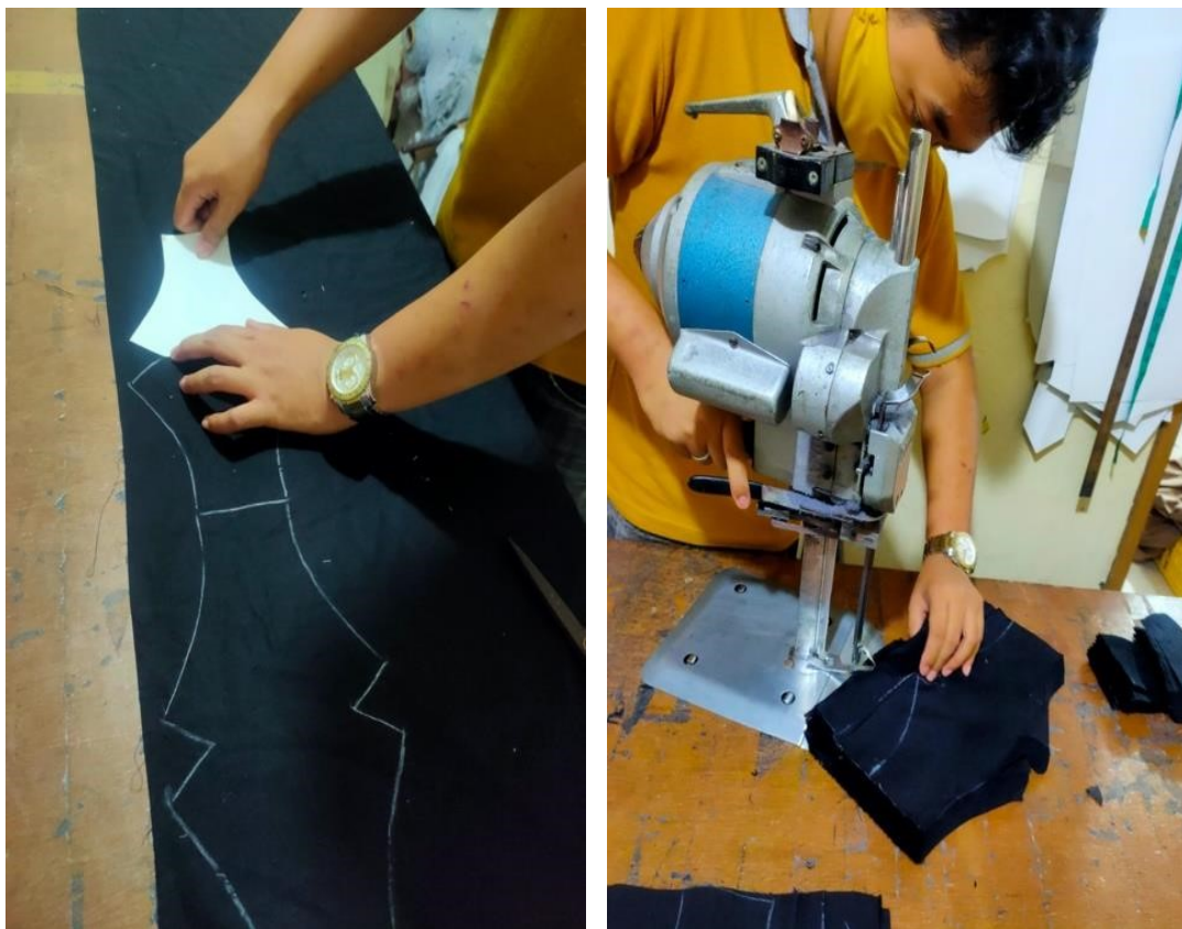
Gambar III. 1 Proses mencetak dan memotong pola masker, Sumber : Dokumentasi Pribadi, 2020
