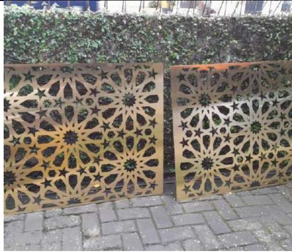
Gambar 32. Supervisi hasil pemotongan plat stainless steel di workshop *Estha Lasercutting* (Pertengahan Maret 2023)
