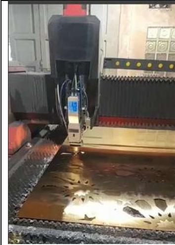
Gambar 31. Supervisi proses pemotongan plat stainless steel dengan Teknik *lasercutting* di workshop
