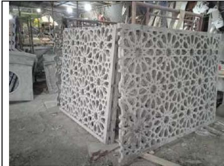
Gambar 28. Supervisi pekerjaan produksi di workshop PT. Nuansa GRC untuk lempeng kerawangan yang sudah selesai dicetak sesuai modul yang dipesan. (Awal Januari 2023) (Sumber : arsip panitia renovasi)
