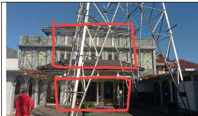
**Gambar 1** : asinkronitas modul fasade masjid hasil renovasi dengan modul teras masjid. Bentuk atap kanopi teras menutupi unit jendela pada lantai atas, dan mengaburkan aksentuasi pada fasade. (Sumber : arsip panitia renovasi)
