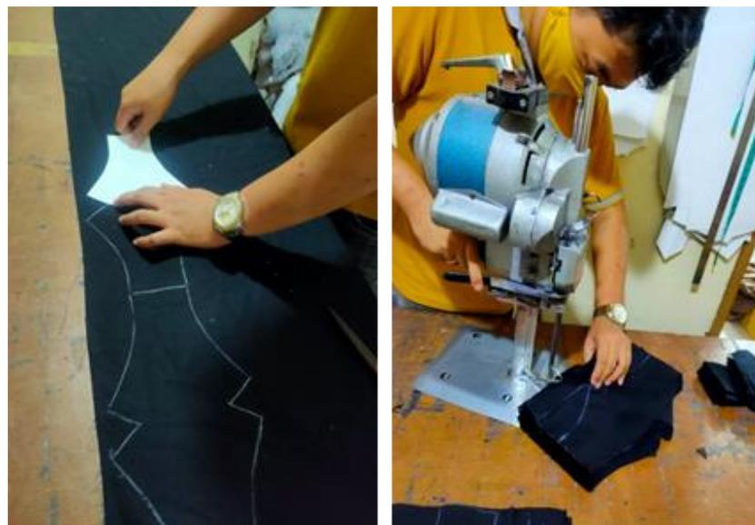
**Gambar IV.8** Proses mencetak dan memotong pola masker
