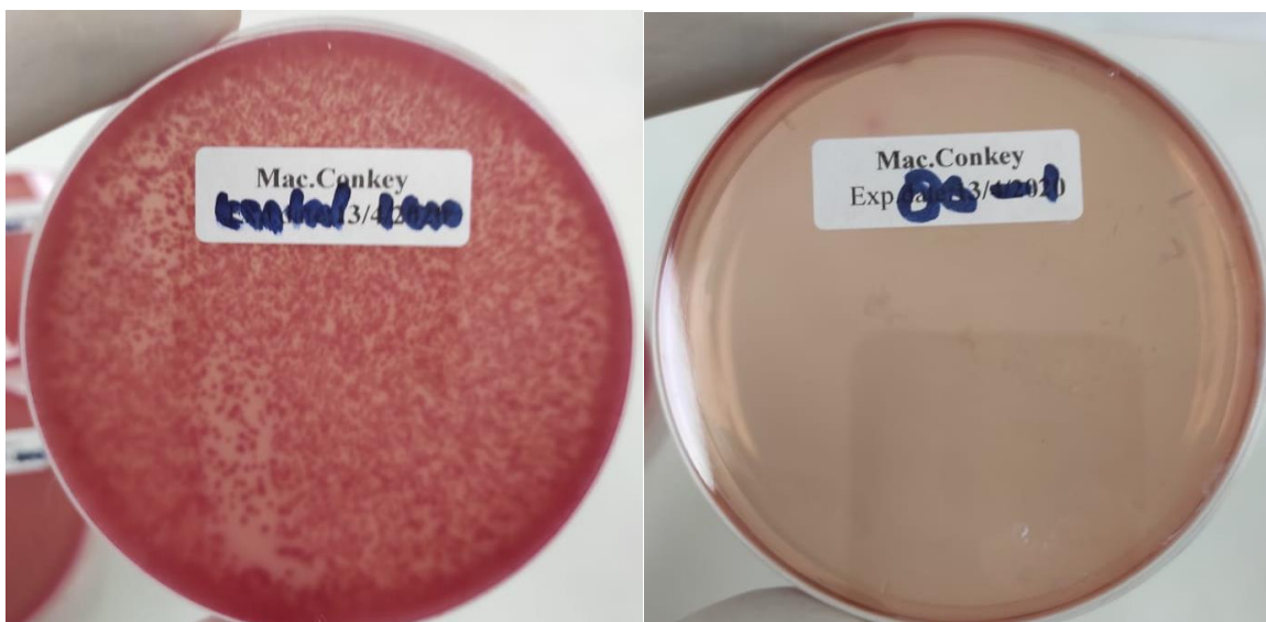
Gambar 1. Hasil uji efektifitas HSU. (Kiri) tanpa HSU. (Kanan) dengan HSU. Titik merah merupakan bakteri E. coli yang ditumbuhkan pada cawan MacConkey.
