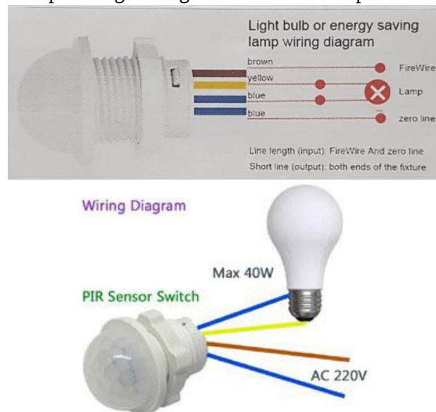
Gambar 6. Cara Koneksi Sistem Penerangan dengan Sensor PIR
