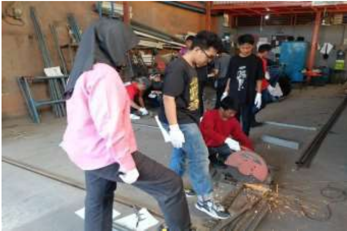
Gambar 29. Proses Pemotongan Bahan Menggunakan Mesin gerinda Duduk
