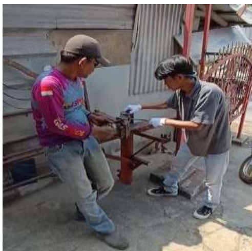
Gambar 37 Instruktur Memandu Tahapan Mengerol.
