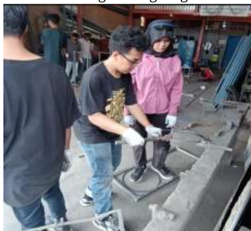
Gambar 36. Mengerol Bahan Untuk Komponen Yang Melengkung
