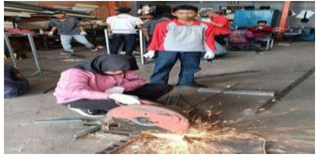
Gambar 9. Proses Pemotongan Bahan Menggunakan Mesin gerinda Duduk
