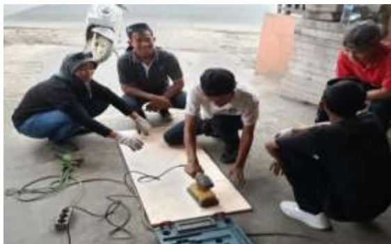
Gambar 16. Mengampelas Alas Meja Bar yang Terbuat Dari Kayu
