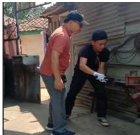
Gambar 36. Mengerol Bahan Untuk Komponen Yang Melengkung
