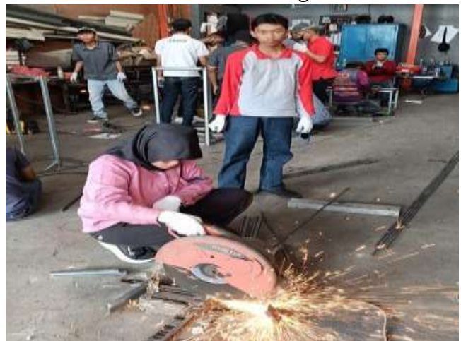
Gambar 28. Proses Pemotongan Bahan Menggunakan Mesin gerinda Duduk
