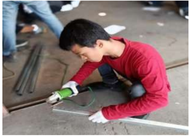
Gambar 30. Menggunakan Gerinda Tangan
