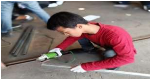
Gambar 10. Menggunakan Gerinda Tangan
