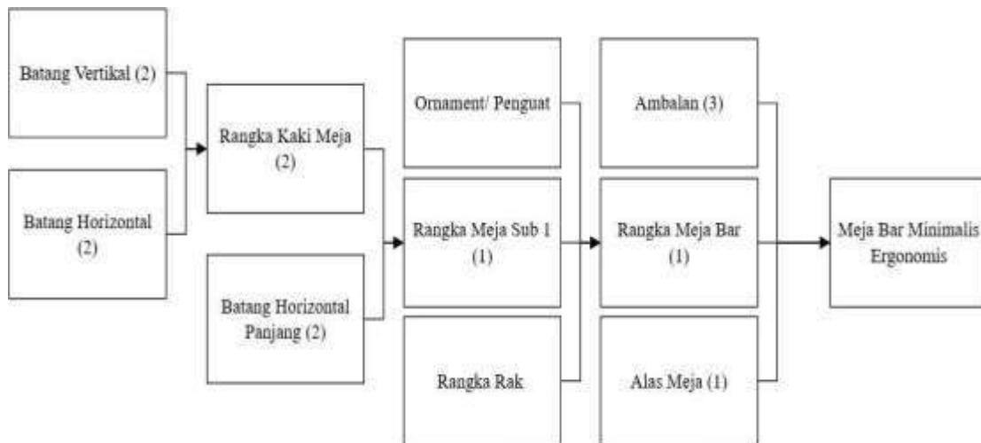
Gambar 44. Diagram Perakitan Meja Bar
