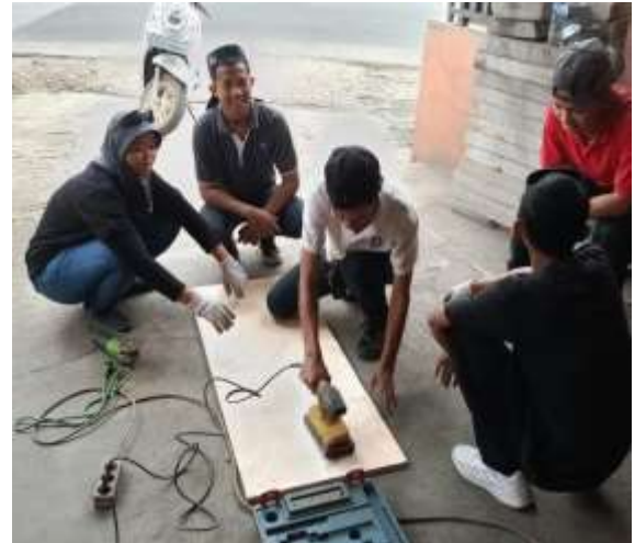
Gambar 42. Mengampelas Alas Meja Bar yang Terbuat Dari Kayu
