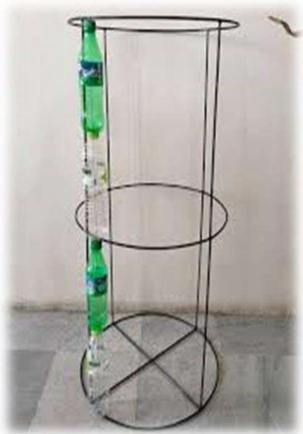
Rangka Plastik Sampah Bundar Kaki 3 Bahan Besi Bulat 10 Mm
