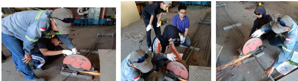
Gambar 14 Pengukuran dimensi komponen dan memotong menggunakan gerinda duduk
