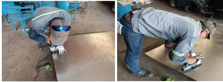
Gambar 21 Memotong pelat untuk alas meja menggunakan jigsaw
