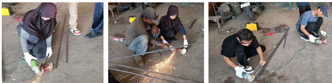
Gambar 15 Merapikan ujung batang besi nako dan mempersiapkan kampuh lasan menggunakan gerinda tangan
