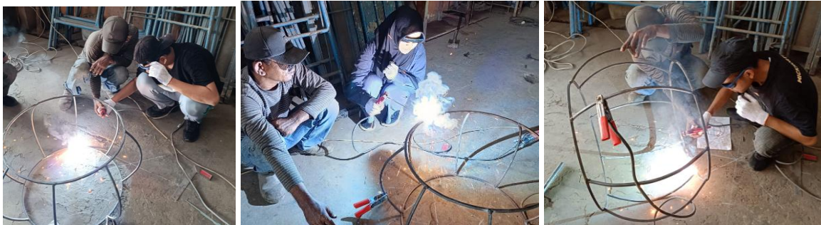
Gambar 18 Persiapan Mengelas Komponen Meja
