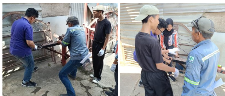
Gambar 16 Mengerok (Melengkungkan) bahan besi nako sesuai ukuran
