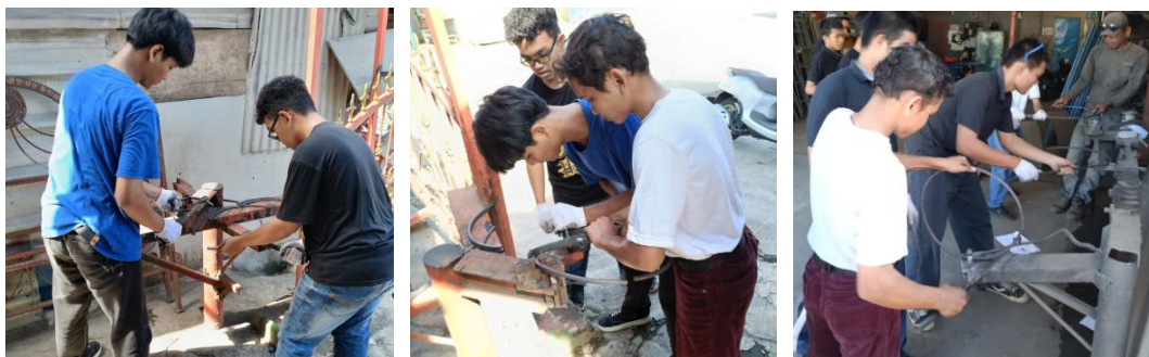
Gambar 15 Melengkungkan (mengerol) besok nako menjadi lingkaran atau bentuk lainnya
