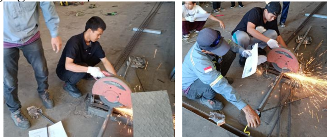
Gambar 13 Memotong besi nako untuk bahan komponen kursi
