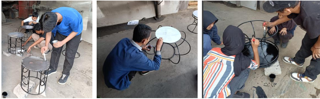
Gambar 22 Mengecat kursi. Alas kursi dicat warna silver dan rangka kursi dicat warna hitam
