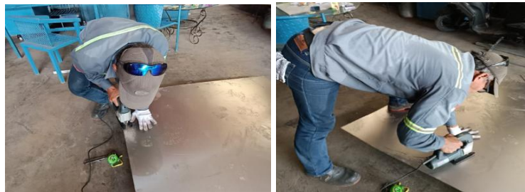
Gambar 20 Memotong pelat untuk alas kursi menggunakan jigsaw
