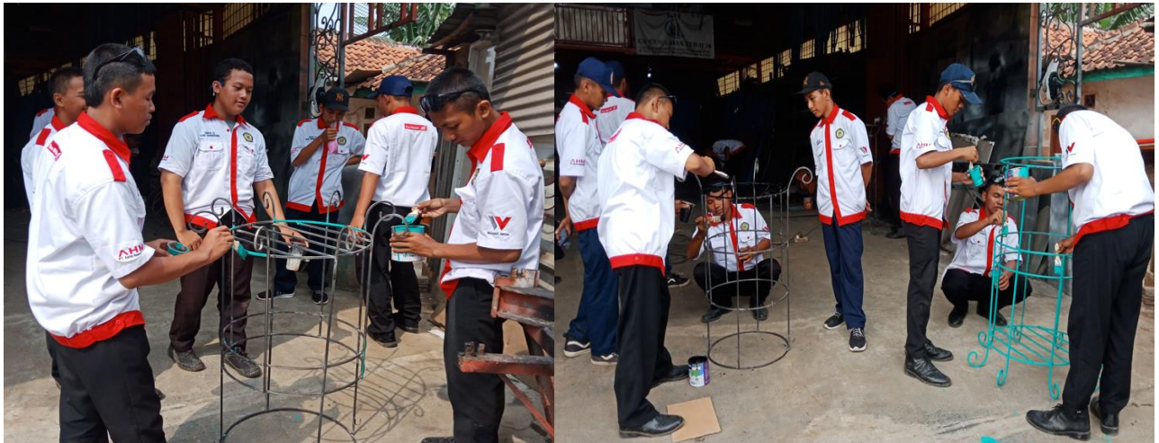
Gambar 15. Proses pengecatan rangka
