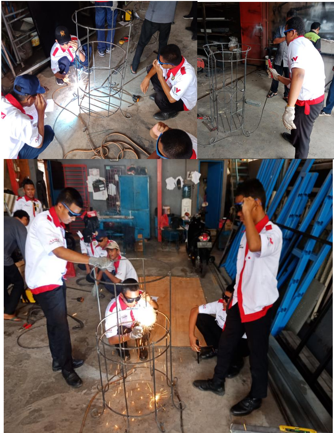
Gambar 12. Proses Pengelasan /Perakitan
