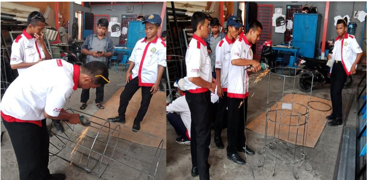
Gambar 14. Proses Penghalusan Sambungan
