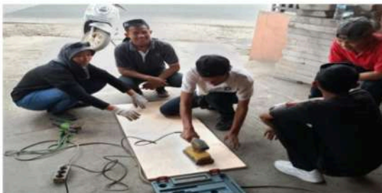
Gambar 16. Mengampelas Alas Meja Bar yang Terbuat Dari Kayu
