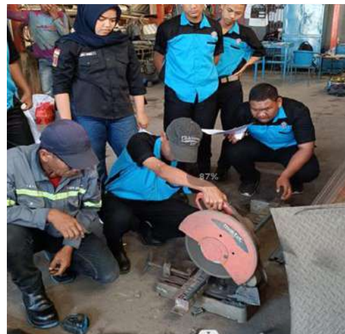
Gambar 21. Panduan Memotong Menggunakan Gerinda
