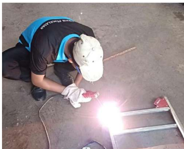
Gambar 23. Penyambung Bahan Menggunakan Teknik Pengelasan
