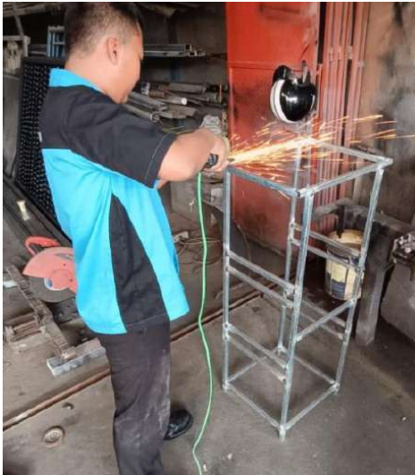
Gambar 26. Menggerinda Kampuh Las
