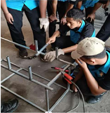
Gambar 24. Penyambung Bahan Menggunakan Teknik Pengelasan
