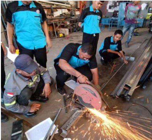
Gambar 22. Memotong Menggunakan Gerinda Mesin.
