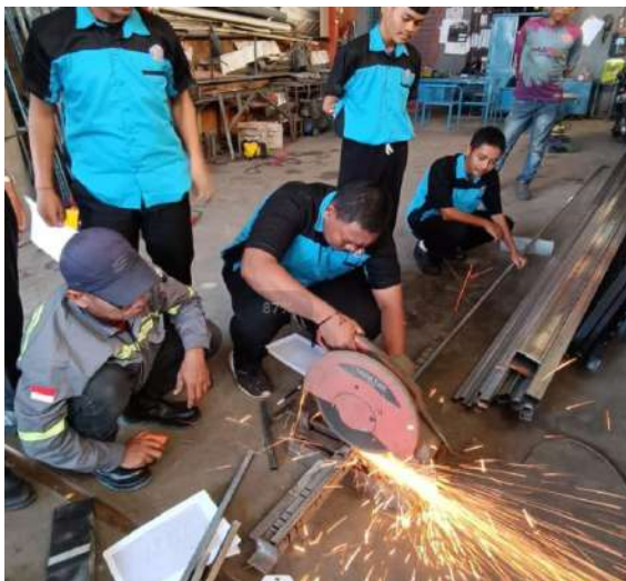
Gambar 22. Memotong Menggunakan Gerinda Mesin.
