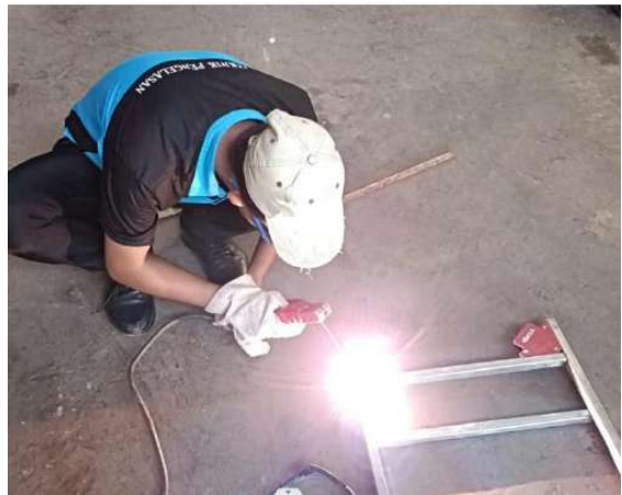
Gambar 23. Penyambung Bahan Menggunakan Teknik Pengelasan
