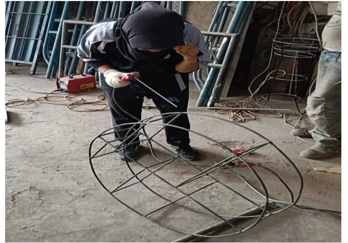
Gambar 8. Mengelas (Merakit Komponen)
