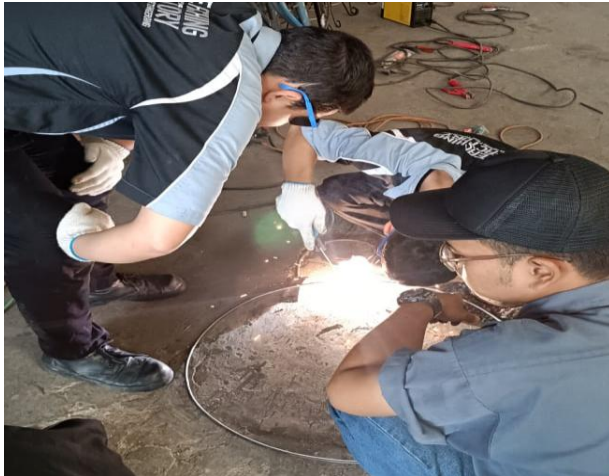
Gambar 7. Mengelas (Merakit Komponen)
