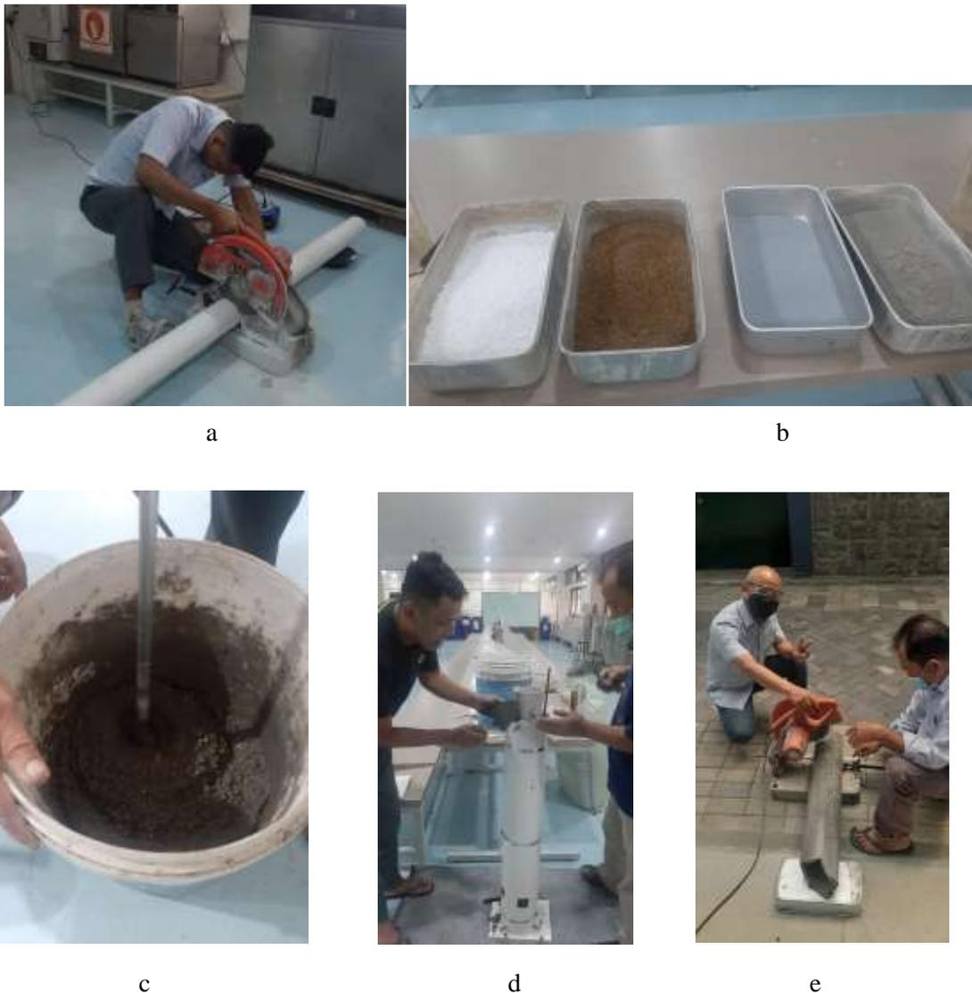
Gambar 3. Proses pembuatan buis beton, a) Pembuatan cetakan, b) persiapan bahan, c) pencampuran, d) pencetakan, e) pemotongan
