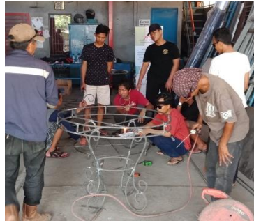
Gambar 21. Menggabungkan Rangka Meja
