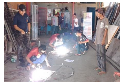
Gambar 19. Praktik Mengelas Lingkaran Rangka Meja
