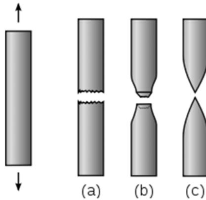
Gambar 2 - Tipe Failure pada Material Baja
