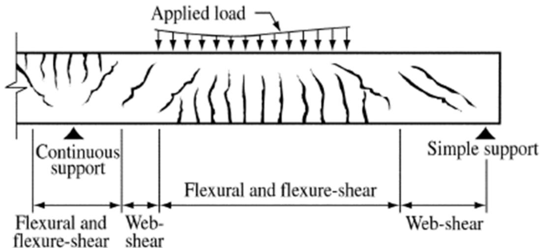
Gambar 3 – Crack pada Beton Bertulang
