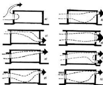
Desain masjid Al-Muhajirin didesain dengan mempertimbangkan *cross* ventilasi dengan pemasangan jendela dan pemakaian roster untuk aliran udara alami sehingga terjadilah pergerakan dan pergantian udara (aliran udara) sehingga nyaman ruang untuk pengudaraan alami dapat tercapai.
