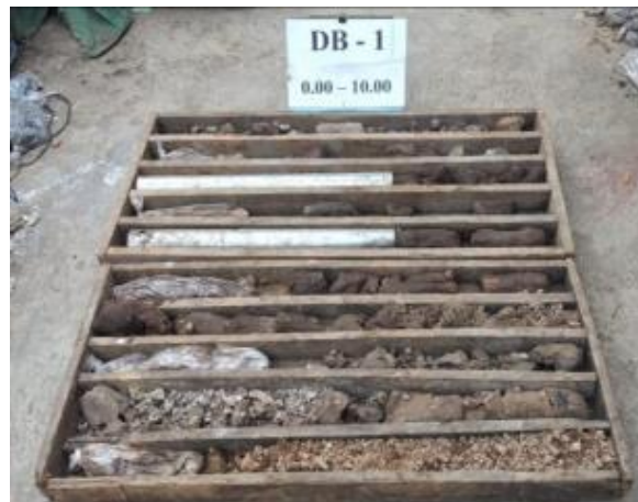
Gambar 4.12. Foto Hasil Uji Standar Penetrasi Tes pada kedalaman 0.00 – 10.00 meter
