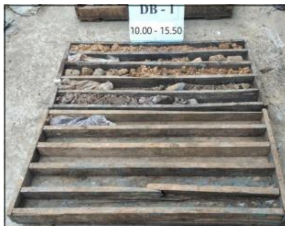
Gambar 4.13. Foto Hasil Uji Standar Penetrasi Tes pada kedalaman 10.00 – 15.50 meter
