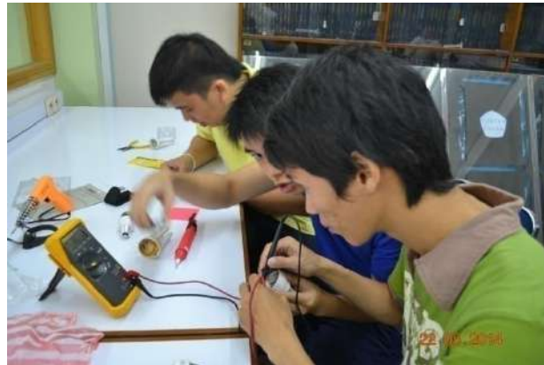
Gambar A.1. Pengetesan komponen elektronik lampu CFL dengan Avometer
