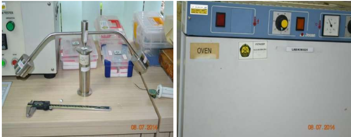
Gambar 5.13. Ball Pressure Tester (Alat uji ketahanan terhadap panas) (P3TK EBTKE)
