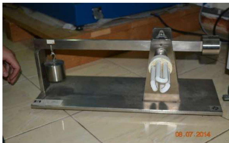
Gambar 5.14. Alat uji kuat mekanis (uji puntir) (P3TK EBTKE)
