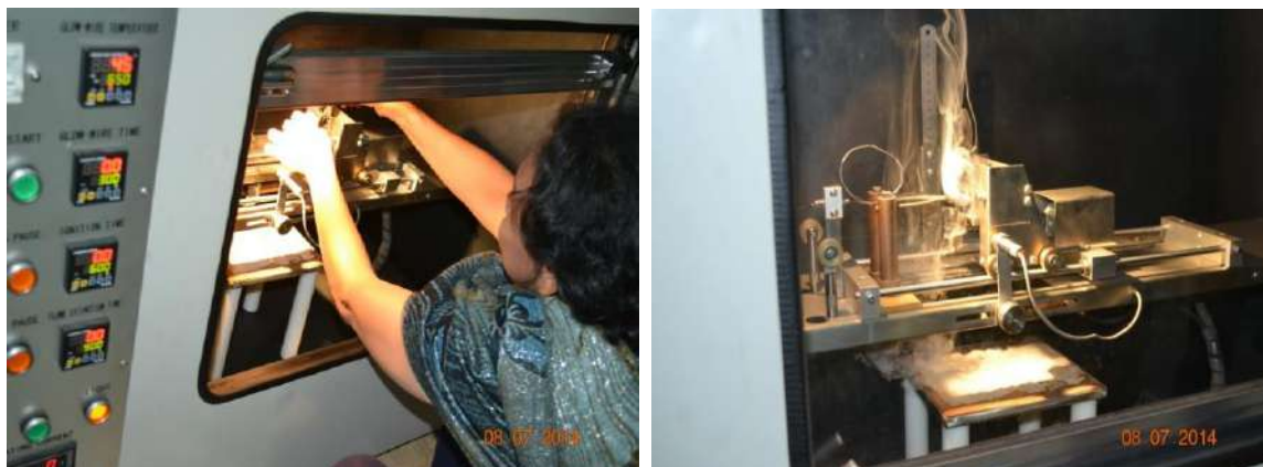
Gambar 5.12. Glow Wire Tester (Alat uji ketahanan & percikan api) (P3TK EBTKE)
