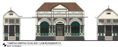
Gambar 27. Tampak muka bangunan digambar ulang hasil pengukuran lapangan.
