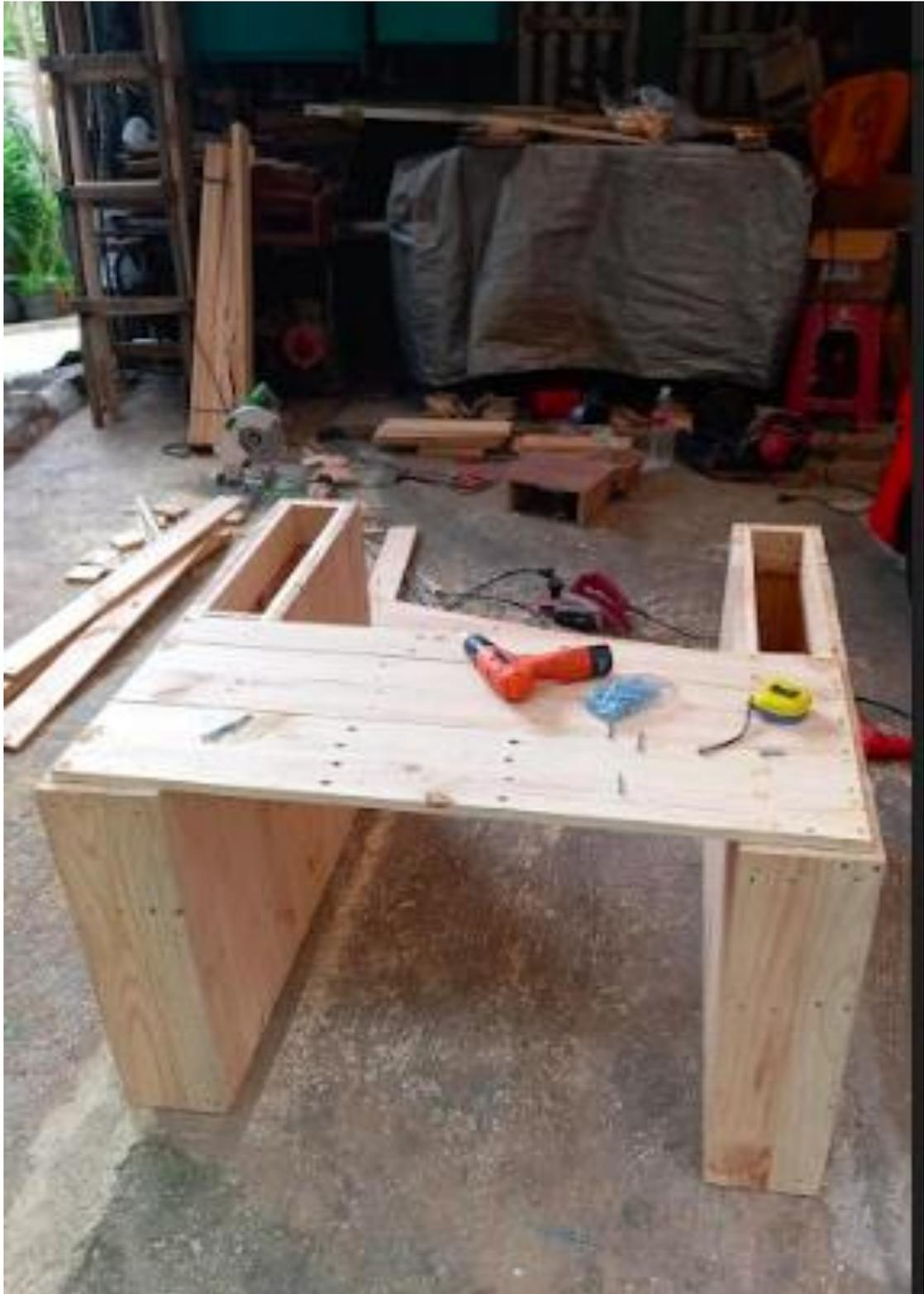
Gambar 4. Proses Pemotongan dan Perakitan Material sesuai Ukuran Gambar Kerja
