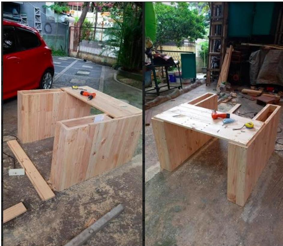
Gambar 3. Proses Pemotongan dan Perakitan Material sesuai Ukuran Gambar Kerja
