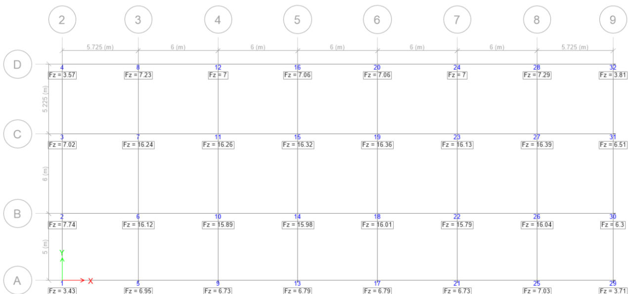
Gambar 7 Reaksi Kolom Akibat Beban Dead Load, Satuan Ton
