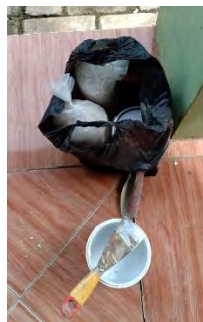
Gambar 12. Bahan dan Alat untuk Pekerjaan Plamir Tembok (Sumber: Dokumentasi, April 2020)
