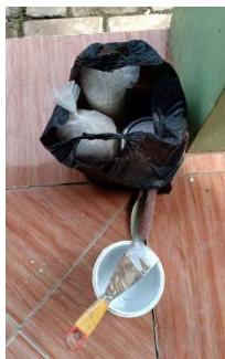
Gambar 10. Bahan dan Alat untuk Pekerjaan Plamir Tembok (Sumber: Dokumentasi, April 2020)
