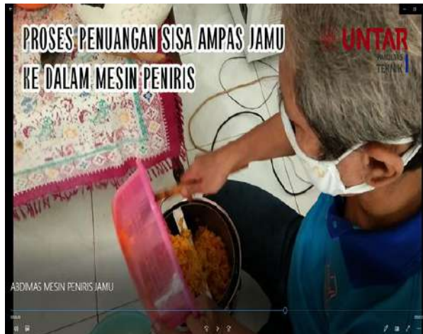
Gambar 2.7 (a) Ampas Jamu Dimaskukan Ke dalam Mesin Peniris. (b) Penirisan Jamu Sumber: Penulis, 2022
