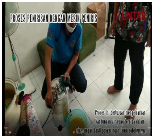
Gambar 2.7 (a) Ampas Jamu Dimaskukan Ke dalam Mesin Peniris. (b) Penirisan Jamu Sumber: Penulis, 2022
