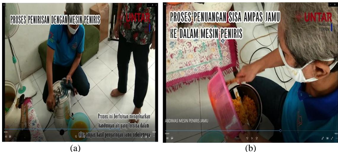
Gambar 2.7 (a) Ampas Jamu Dimasukkan Ke dalam Mesin Peniris. (b) Penirisan Jamu
