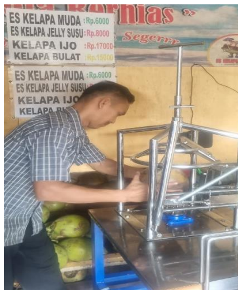
Gambar 8. Praktik Penggunaan Mesin Pengupas Kelapa
