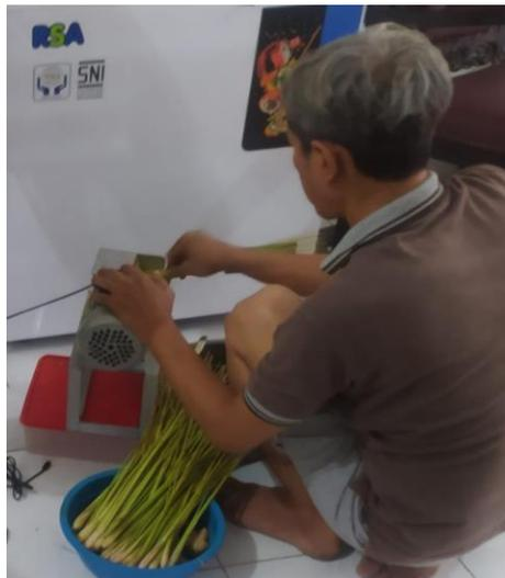
Gambar 2.4 Proses Penyerutan Rempah-Rempah
