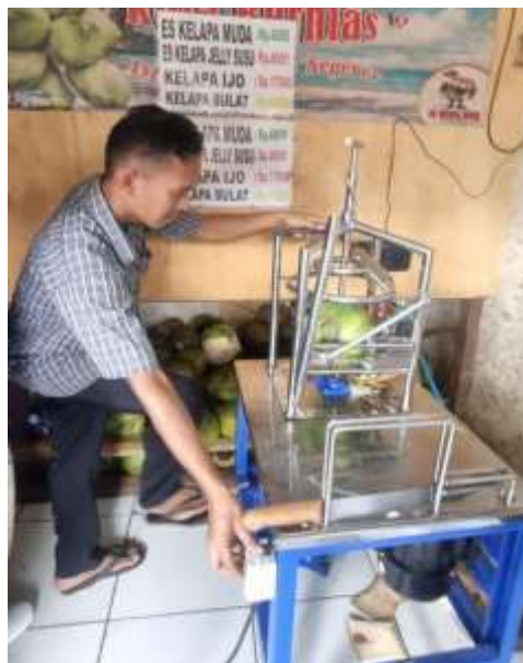
Gambar 6. Proses Pengupasan Kelapa Dengan Menggunakan Mesin
