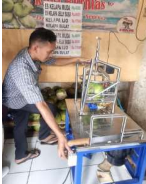
Gambar 9. Proses Pengupasan Kelapa Dengan Menggunakan Mesin
