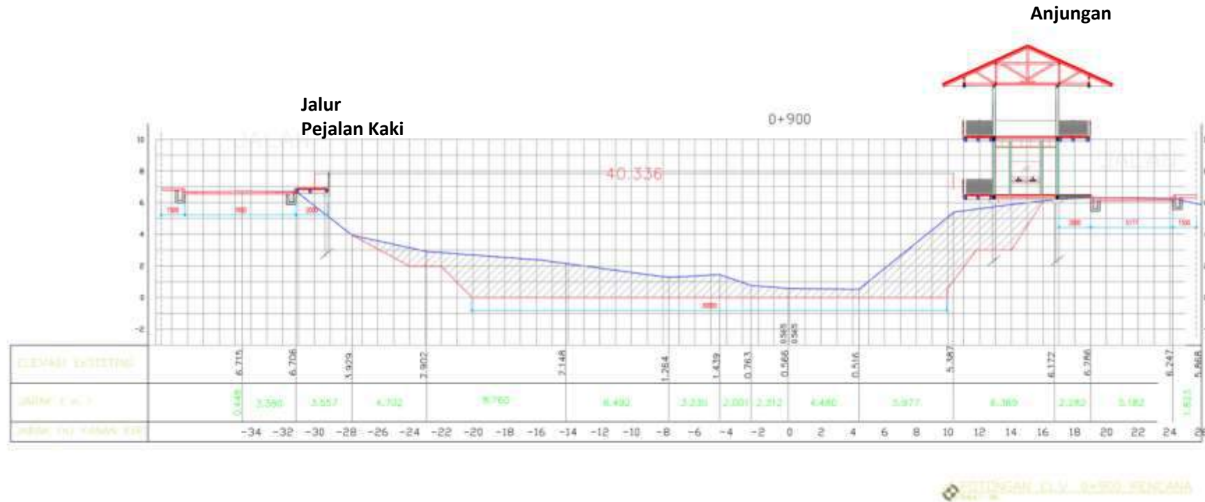
Potongan Tipikal 1 - STA 0+900 (Jalur Pejalan Kaki dan Anjungan)
