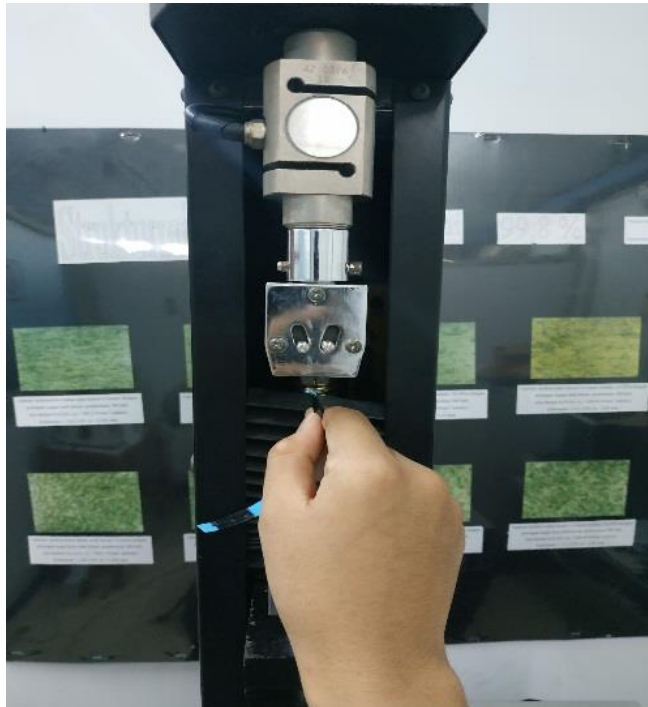
Gambar 10. Uji Tarik Spesimen
