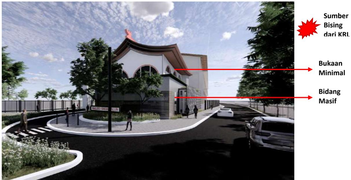
Gambar 10. Penerapan Bidang Masif untuk Mengurangi Kebisingan pada Sisi Barat Bangunan
