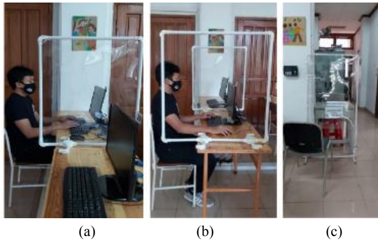
Gambar 12. (kiri) Mock-Up sekat yang telah disetujui. Setelah diujicobakan sekat berukuran tinggi 70cm dan lebar 60 cm ini ternyata perlu diperlebar karena saat posisi siswa duduk bersandar sekat tidak melindungi saat siswa menoleh ke sisi kanan Gambar 13. (tengah) Mock-Up sekat setelah diperlebar menjadi berukuran t:70 cm dan l. 70 cm. Terlihat bahwa saat bersandar posisi siswa tetap terlindungi oleh sekat. Gambar 14. (kanan) Sekat berukuran tinggi, tidak hanya dapat menjadi penyekat antara meja guru dan siswa, namun juga dapat digunakan untuk partisi pembatas dalam berbagai keperluan sebelum pembelajaran berlangsung. Peragaan oleh Tim PKM, Ganesha Pratama Adi. Sumber: Tim Penulis, 2020
