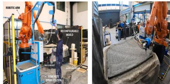
**Gambar 5.** Penyemprotan beton robotik otomatis pada segmen cangkang bergaris dengan kelengkungan ganda dan ketebalan bervariasi (Oval et al., 2022)
