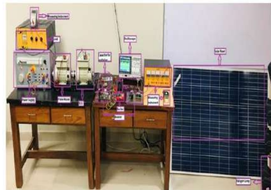
Gambar 8. Model Eksperimen Hybrid antara Teknologi WECS dan Photovoltaic (Mustafa dkk., 2021)
