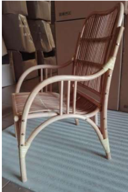
Gambar 5. 29 Kekuatan connector nuts pada joint connector bolts (JCB) yang diterapkan pada kursi rotan, ketika diberi beban duduk. Kursi diujicoba oleh Mr. Takenobu Yamashiro dari Jetro, Jepang. (Foto: Eddy Supriyatna Mz, 2018).
