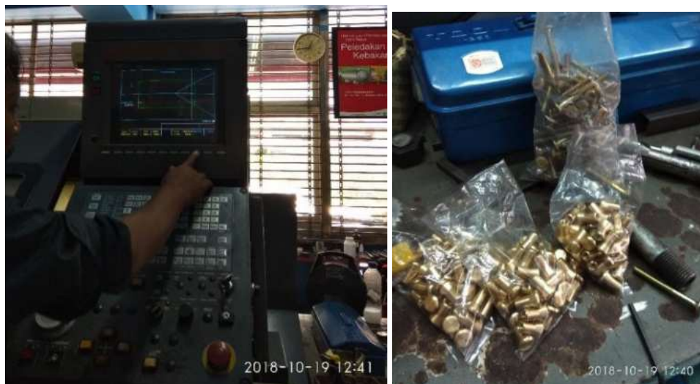
Gambar 5. 26 Pembuatan connector nuts berbahan dasar logam kuningan yang diproses melalui mesin otomatis dan nuts yang dihasilkan.
