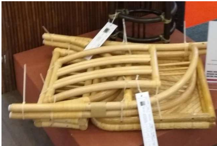
Gambar 5. 30 Pencapaian kondisi final sistem konstruksi knock down, secara teknis mampu diringkas secara praktis pada saat pengemasan, sehingga mengurangi volume pada kontainer dan penyimpanan. (Foto: Eddy Supriyatna Mz, 2018).
