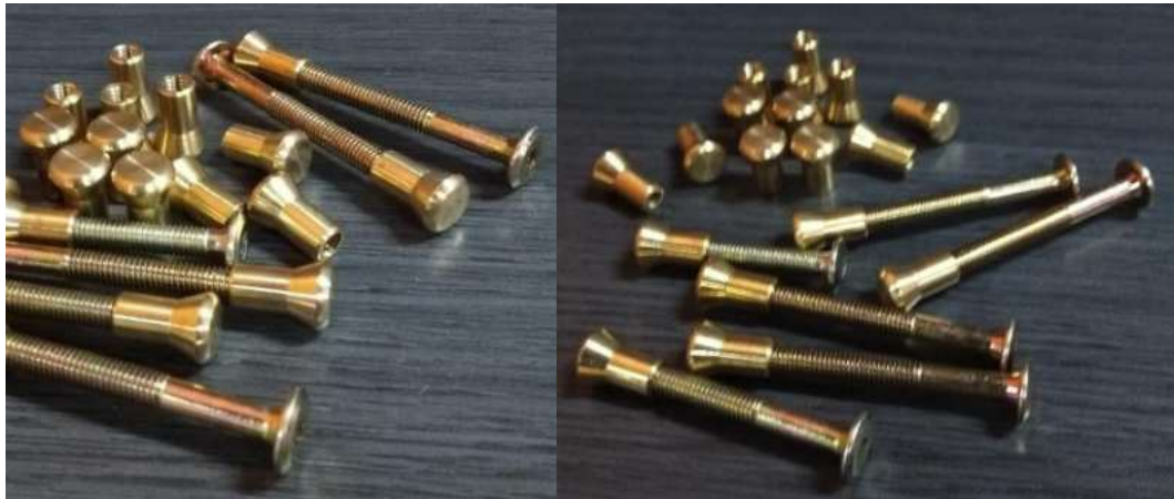
Gambar 5. 27 Ratusan connector nuts pada joint connector bolts (JCB) telah berhasil diproses dan diujicoba menjadi mur (nuts) yang sesuai untuk sistem knock-down pada furniture rotan.
