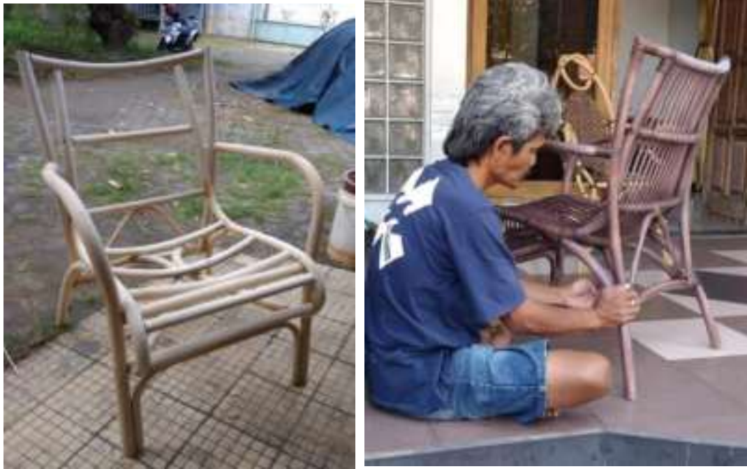
Gambar 4.17. Rangka hasil akhir kursi sistem stacking chair versi 1 dan proses finishing. (Sumber foto: Indra Budi S., 2017)
