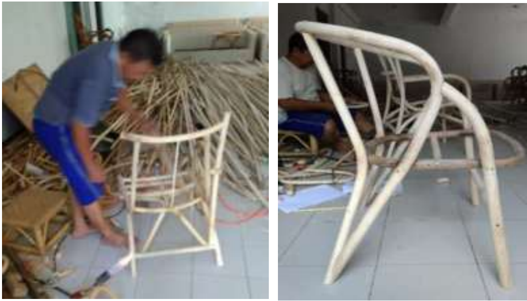
Gambar 4.23. Proses pembuatan rangka stacking chair versi 2. Desainer Eddy Supriyatna Mz. (Sumber foto: Indra Budi S., 2017)
