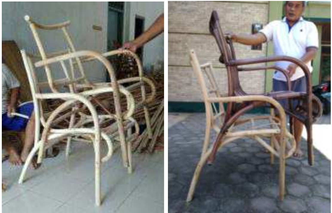
Gambar 4.19. Uji coba susun pada prototype kursi dengan sistem stacking chair versi 1. (Sumber foto: Indra Budi S., 2017)
