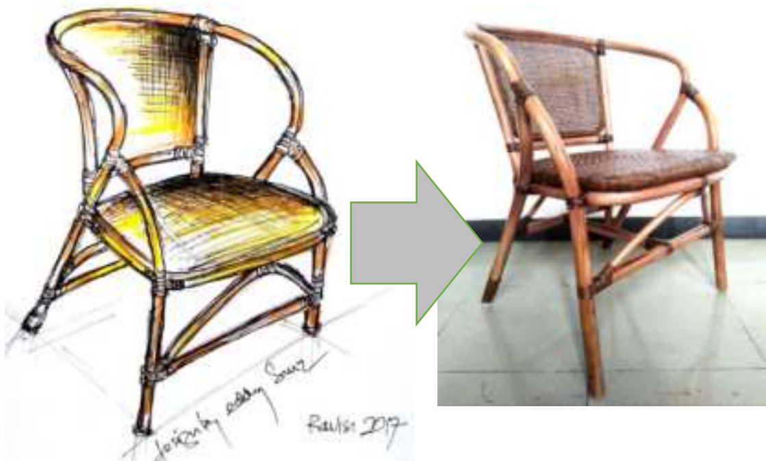
Gambar 4.25. Prototype stacking chair versi 2 dibuat dan disesuaikan dengan sketsa desain yang direvisi. Desainer Eddy Supriyatna Mz. (Sumber foto: Indra Budi S., 2017)
