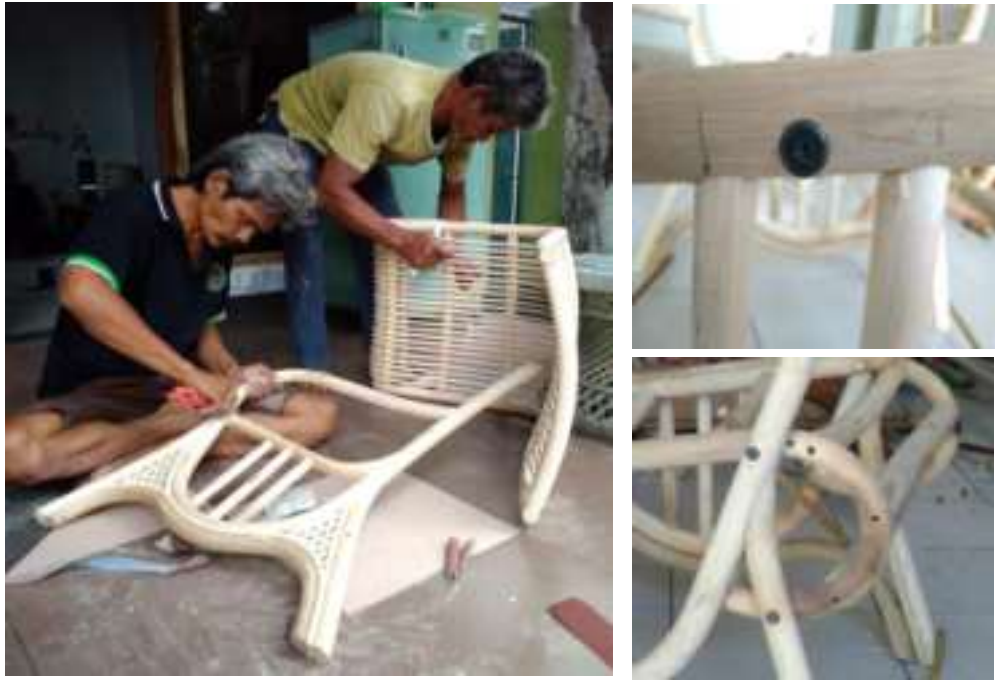
Gambar 4.28. Proses amplas (kiri) dan sistem joint connecting bolt (kanan). Prototype knock down chair versi 1 Desainer Eddy Supriyatna Mz. (Sumber foto: Indra Budi S., 2017)
