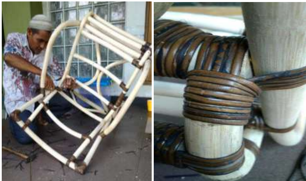
Gambar 4.20. Proses pengikatan dengan kulit rotan untuk memperkuat konstruksi kursi. (Sumber foto: Indra Budi S., 2017)
