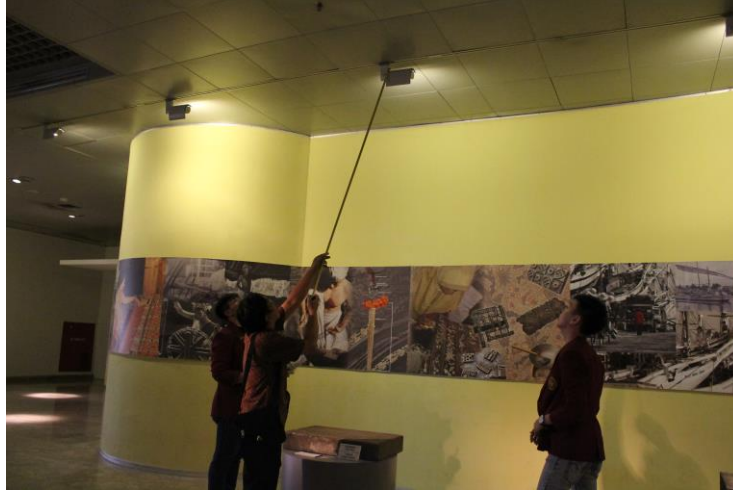
Gambar 4.26 : Pengukuran Jarak Sumber Cahaya ke Obyek
