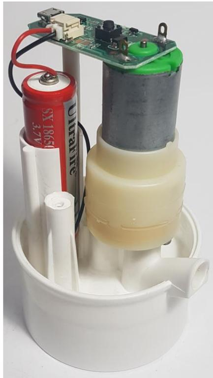
Gambar 2.3. Tampak Dalam dari Pompa Elektrik
