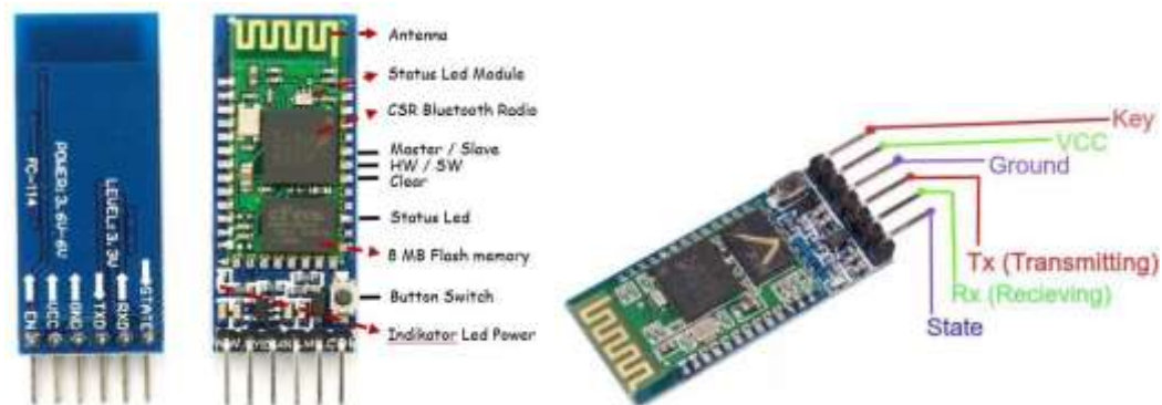
Gambar 2.4 Modul Bluetooth HC05 dan Keterangan Pin
