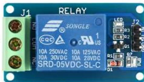
Gambar 2.9 Modul Relay dilihat dari atas
