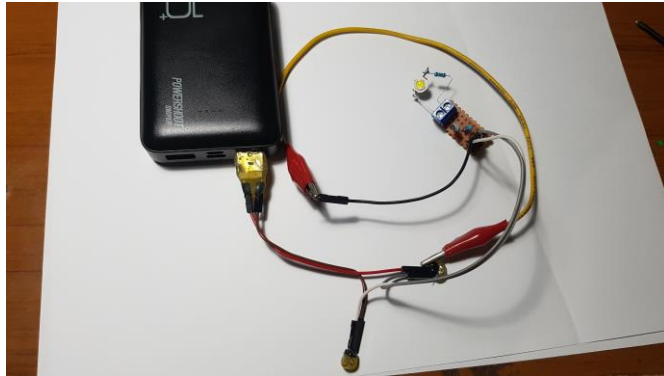
Gambar 4.8 Pengujian Rangkaian Transistor Switching dengan Data “High” Rangkaian transistor dengan karakteristik aktif “low”, jika pin data diberi data low atau dihubungkan ke ground maka transistor akan “on” ditandai oleh lampu yang menyala, sedangkan jika pin data diberi data high atau dihubungkan ke tegangan +5 Vdc maka transistor akan “off” ditandai oleh lampu yang mati.
