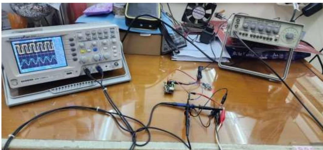
Gambar 4.2 Pengujian Modul Pemancar Sinar Laser
