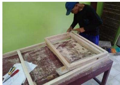
Gambar 11. Penyetelan Rangka
