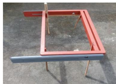
Gambar 14. Pengecatan Rangka Geser Alas Perakitan
