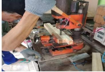
Gambar 16. Pemahatan Rangka Pintu Laci
