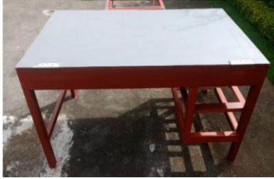
Gambar 15. Pengecatan Rangka Meja Kerja Utama
