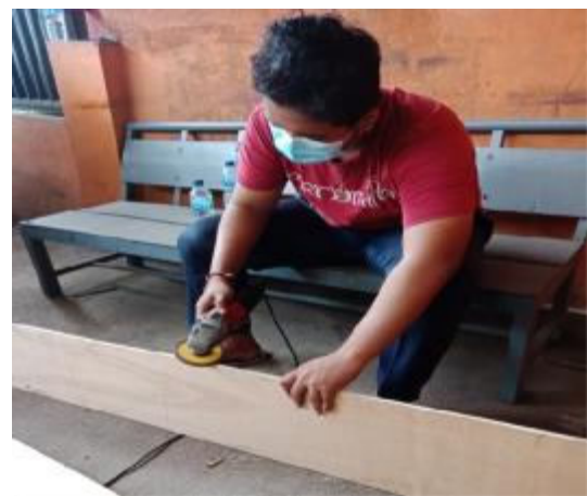
Gambar 15. Menggerinda permukaan potongan kayu supaya rapi Sumber: Sukania et al. (2020)
