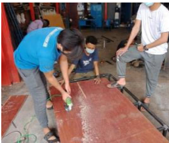
Gambar 14. Memotong kayu lapis penutup lemari menggunakan gergaji mesin Sumber: Sukania et al. (2020)
