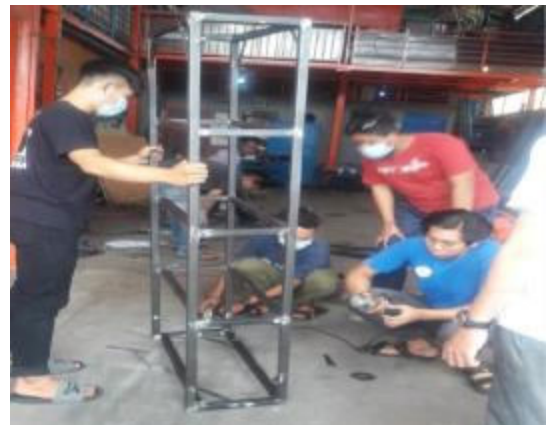
Gambar 9. Menggerinda kampuh las supaya rapi Sumber: Sukania et al. (2020)
