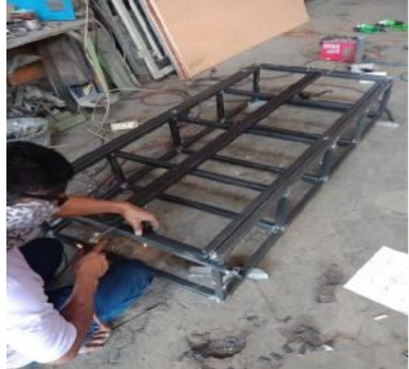
Gambar 11. Mengelas bahan rangka pintu Sumber: Sukania et al. (2020)
