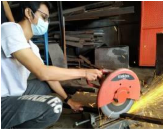
Gambar 6. Memotong bahan menggunakan gerinda duduk Sumber: Sukania et al. (2020)
