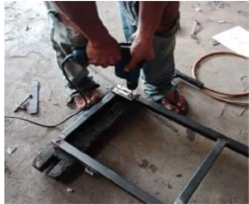
Gambar 17. Merakit slot pintu menggunakan sambungan sekrup Sumber: Sukania et al. (2020)
