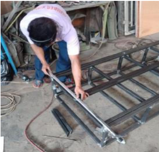
Gambar 10. Penyetelan komponen rangka pintu (Sumber: Sukania et al. 2020)
