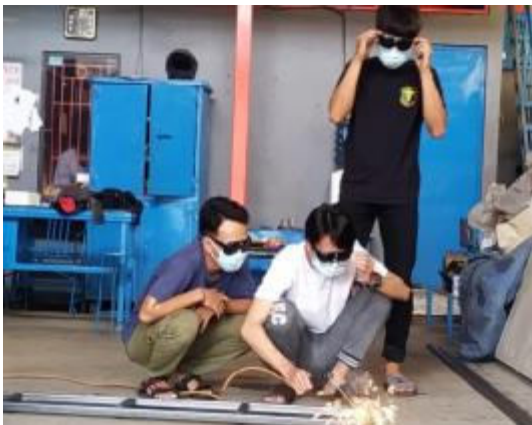
Gambar 8. Menyambung besi hollow menggunakan teknik pengelasan Sumber: Sukania et al. (2020)
