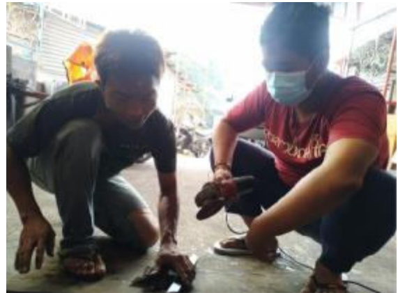
Gambar 7. Merapikan ujung bahan menggunakan gerinda tangan Sumber: Sukania et al. (2020)
