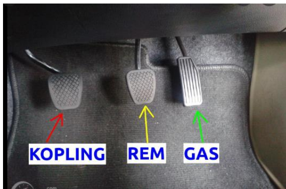
Gambar 1. Pedal Kopling, Pedal Rem dan Pedal Gas Pada Mobil
